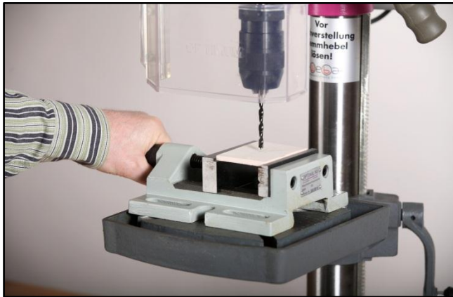
Kleine Bohrungen in kleine Werkstücke: Kein Festspannen des Maschinenschraubstockes notwendig!
