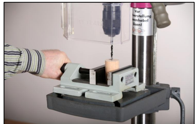
Senkrechtes Einspannen von Rundhölzern mit Hilfe der Prismen im Schraubstock!
