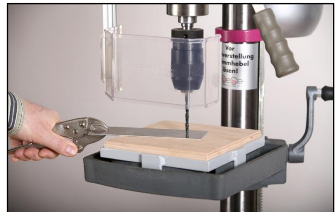
Flache Werkstücke mit Gripzange halten! (Beachte: Bohrunterlage zum Schonen des Bohrtisches verwenden!)
