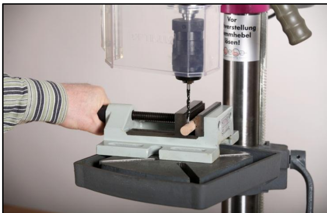
Waagrechtes Einspannen von Rundhölzern mit Hilfe der Prismen im Schraubstock!
