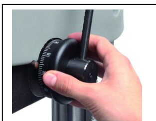
Bohrtiefenanschlag Herausziehen-Tiefe einstellen-Anschlag hineindrücken
