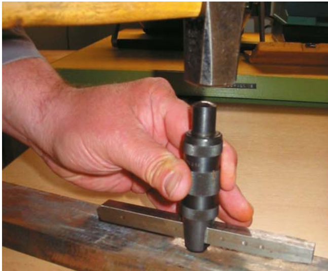
Abb. 4: Poldihammer mit Härtevergleichsstab
