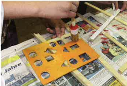
Abb. 8: Beizen der Spielfläche, lackieren der Stütze
