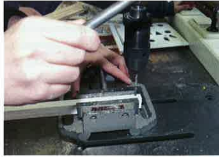
Abb. 9: Bohren der beiden Stützen
