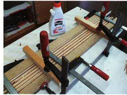
Abb. 6: Zusammenleimen mehrerer Rahmenleisten
