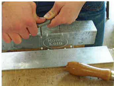
Abb. 7: Gewindeschneiden von Hand
