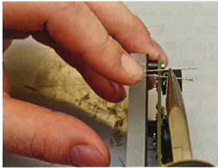
Abb. 13: Biegen der Anschlüsse der LED
