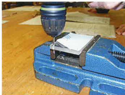
Abb. 8: Gewindeschneiden mit dem Akku-Schrauber mit Einschnittgewindebohrer
