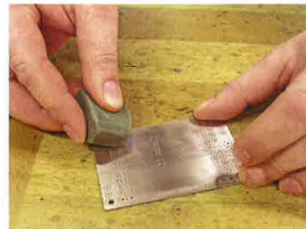
Abb. 10: Reinigen der Lötseite der Platine
