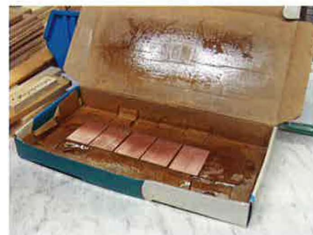
Abb. 11: Mit Lötack eingesprühte Platinen
