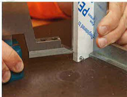
Abb. 9: Anreißern der Bohrpunkte für die LEDs
