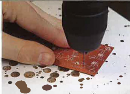
Abb. 5: Aufbohren der gesetzten Bohrpunkte
