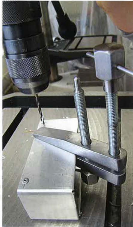
Abb. 10: Bohren des Nietloches zum Fügen von Seitenteil und Boden (Modell A)
