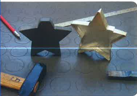
Abb. 6: Hilfskörper zum Biegen der Sternform
