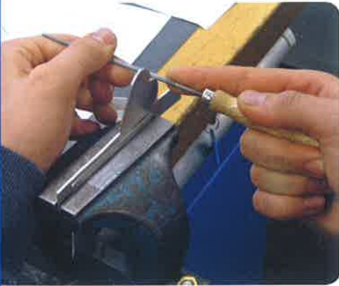
Abb. 5: Nacharbeit der ausgeschnittenen Herzform – Einspannen in geschliffenen Backen
