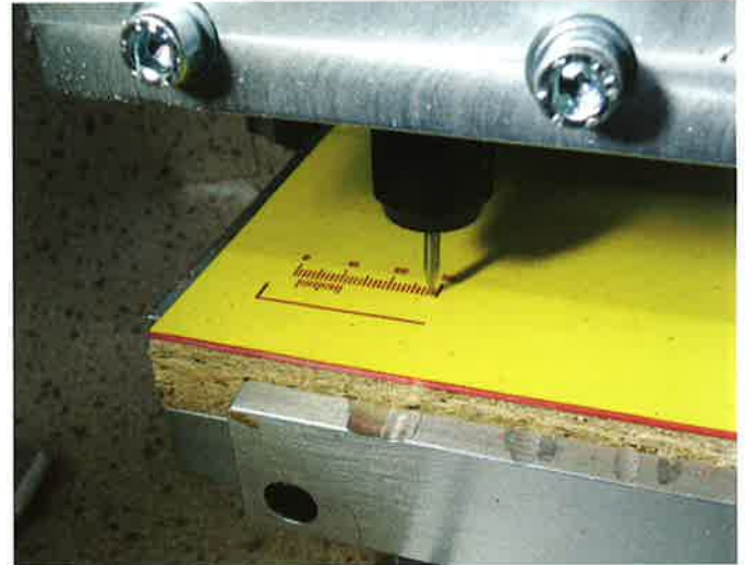
Abb. 6: Gravieren der Skalen mit Stichel
