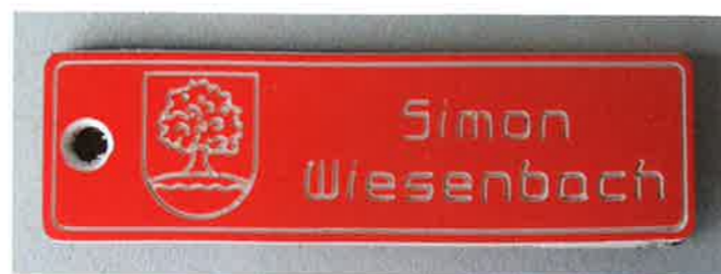
Bild 17: Das fertig ausgefräste Werkstück
