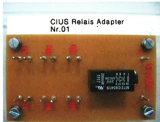
Abb. 2: Relais-Adapter für 1 Port, auch vielfach möglich.
