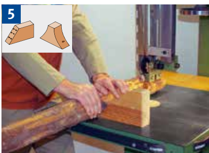
Quersägen von Rundholz mit Keilstütze.
