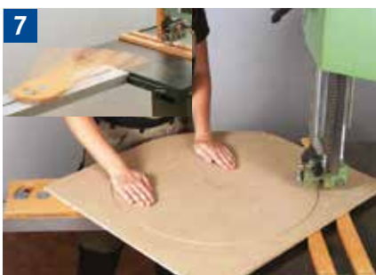
Vorrichtung und Handhaltung beim Herstellen kreisförmiger Werkstücke.
