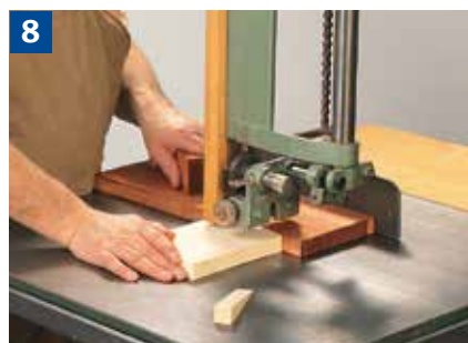
Sägen von Keilen mit Keilschneidlade.
