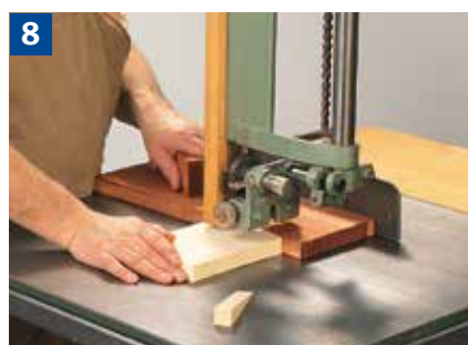
Sägen von Keilen mit Keilschneidlade.
