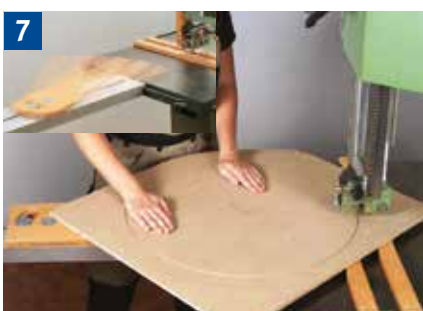
Vorrichtung und Handhaltung beim Herstellen kreisförmiger Werkstücke.
