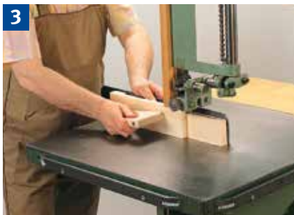
Auftrennen am Anschlag mit Zuführlade.
