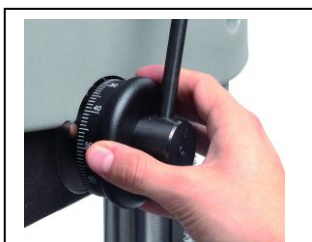
Bohrtiefenanschlag Herausziehen-Tiefe einstellen-Anschlag hineindrücken
