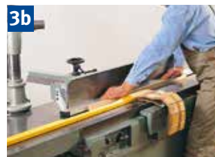
3b Abrichten und Fügen schmaler Werkstücke mit Fügeleiste und Hilfsanschlag.
