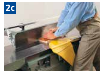
2c Abrichten kurzer Werkstücke mit Gliederschwingschutz und Zuführlade.
