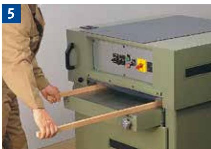
Hobeln schmaler Werkstücke. Bei starren Einzugsrollen und Druckbalken maximal zwei Werkstücke gleichzeitig bearbeiten.
