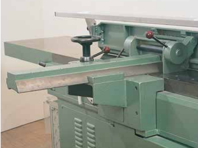
Anschlagführung ist gleichzeitig Messerwellenverdeckung
