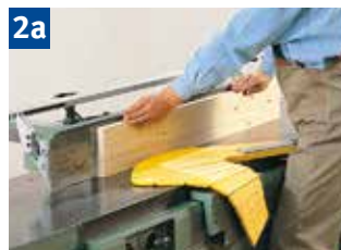
2a Fügen breiter Werkstücke mit Gliederschwingschutz.
