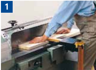
1 Abrichten breiter Werkstücke mit Schutzbrücke.
