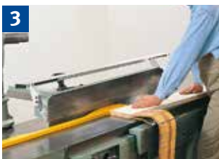
3 Abrichten breiter Werkstücke mit Fügeleiste und Klappenschutz.
