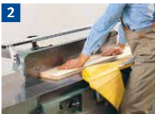
2 Abrichten breiter Werkstücke mit Gliederschwingschutz.
