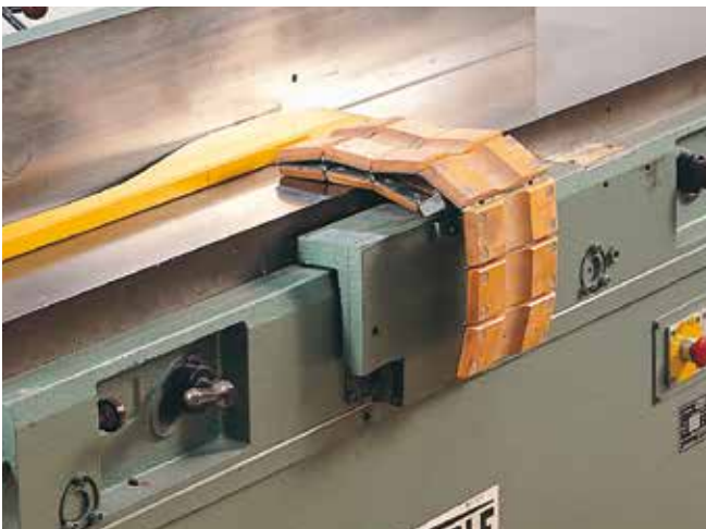
Klappenschutz mit Fügeleiste
