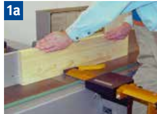
1a Fügen breiter Werkstücke mit Schutzbrücke.
