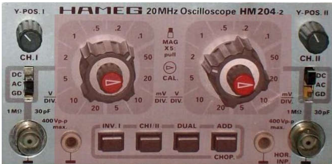
Abb. 6: Einstellung des Y-Verstärkers
