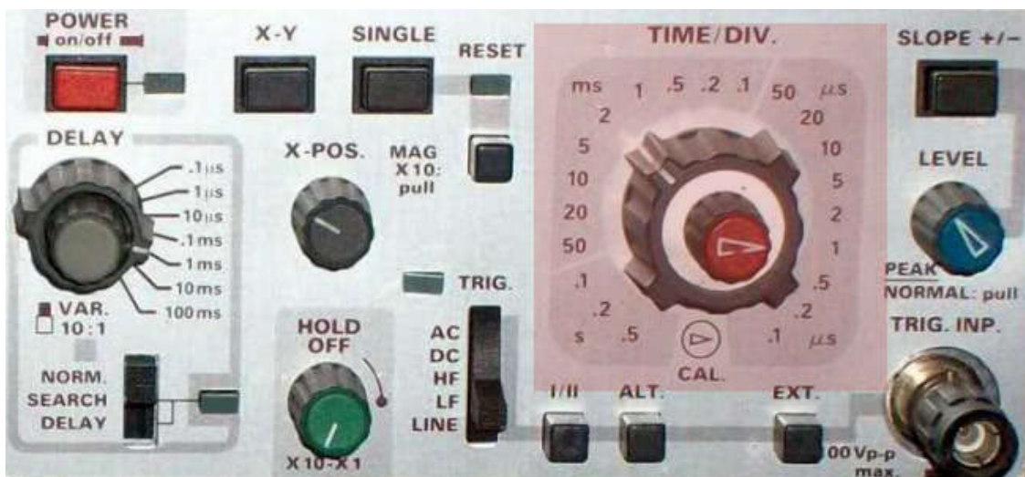
Abb. 4: Einstellung von Time/DIV. und Triggerung
